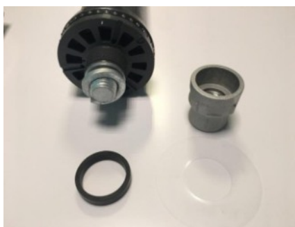
2. verwijder aluminium anker, rubber ring en plastic sheet
